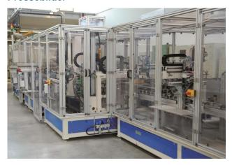
**Bildunterschrift:** Bohrfuttermontage RÖHM: Im RÖHM Stammwerk Sontheim/Brenz werden pro Monat ca. 500.000 Bohrfutter gefertigt. Die vollautomatisierte Produktion hängt in besonderem Maße von einem funktionierenden PLM System ab.
