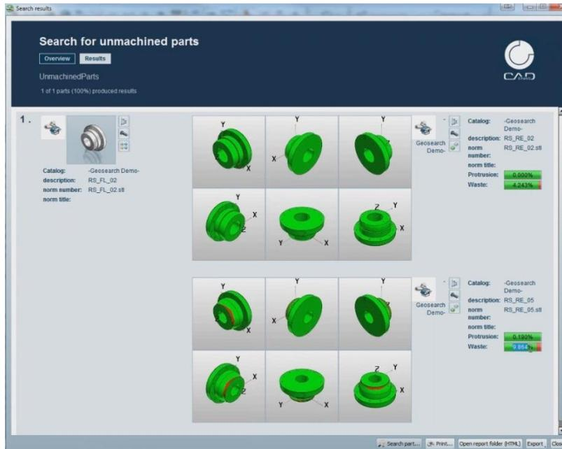
Bildunterschrift 1: Mit der neuen Rohteilsuche können Nutzer in CADENAS PARTsolutions ausgehend von einem konstruierten Fertigteile nach vorhandenen Rohteilen in ihrem Unternehmen suchen.
